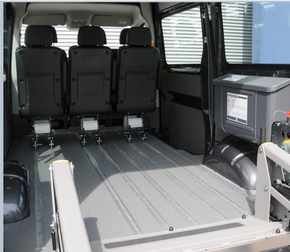
Durch den Smartfloor Systemboden ist die flexible Beförderung von Personen mit und ohne Rollstuhl möglich
